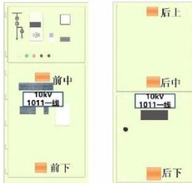
通常检测柜体的前中、前下，后上、后中、后下柜体门缝隙位置。
