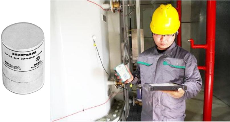
接触式超声波传感器接收方式跟内置的开放型超声波传感器不一样，传感器接触面需要良好的跟被测设备接触，必要的时候需要涂抹耦合剂，以保证接触面到传感器之间的声阻尽可能最小。
