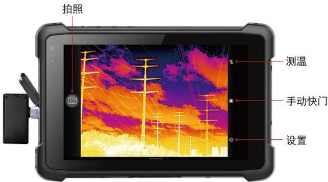
【拍照】点击此图标
