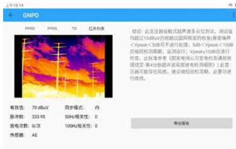
5.测试数据里面拍摄的红外热像数据可以导出到检测报告里。
