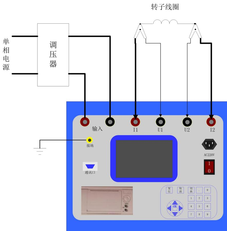
注：试验时使用单相调压器，因此会导致现场供电系统有零序电流产生，所以为了避免零序保护跳闸，最好使用隔离型的调压器。
