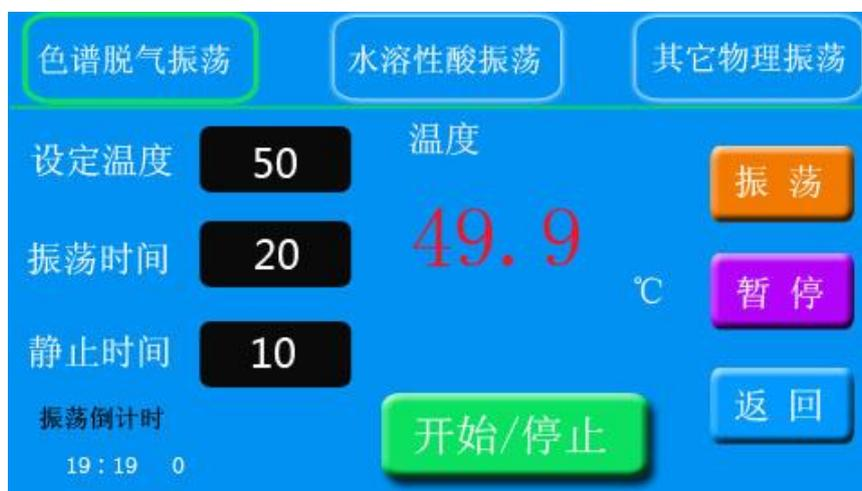
此时，按“开始/停止”键，屏幕提示：‘升温’待温度上升到设定温度后开始振荡并倒计时。20 分钟后停止振荡，开始静止倒计时。10 分钟后，倒计时为 0 并伴有蜂鸣器“嘀，嘀，嘀”报警音。点击“开始/停止”键，提示信息消失。整个实验结束。
