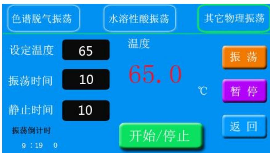
此时，依次点击设定温度、振荡时间、静止时间等选项的数字可对按该选项进行依次设定。点击“开始/停止”键，屏幕提示：‘升温’待温度上升到设定温度后开始振荡并倒计时。振荡结束后，开始静止倒计时。静止时间到后，倒计时为0并伴有蜂鸣器“嘀，嘀，嘀”报警音，点击停止结束键，提示信息消失。整个实验结束。
