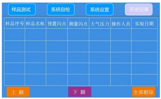
"上翻"、"下翻"按钮用以翻页查询,"清除"按钮用于清空记录存储区的所有数据记录。点击样品序号可打印该条测试记录,同时通过232接口上
