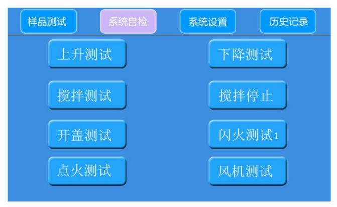
点击"上升测试",测试臂组件升起;点击"下降测试",测试臂组件落下。 点击"搅拌测试",启动搅拌;点击"搅拌停止",停止搅拌。
