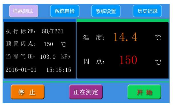
点击"开始",测试臂落下,开始测试并有一个正在测定的提示图片; 点击"终止",停止试验,升降杆升起同时提示图片消失。
