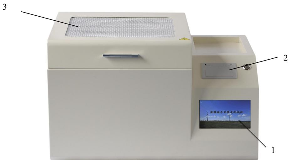
注释：1. 液晶显示屏；2. 打印机；3. 油杯仓盖；4. 电源插口 5. 地线柱；
