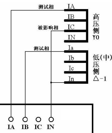
Y 侧相位调整，无零序修正，按单相短路接线
