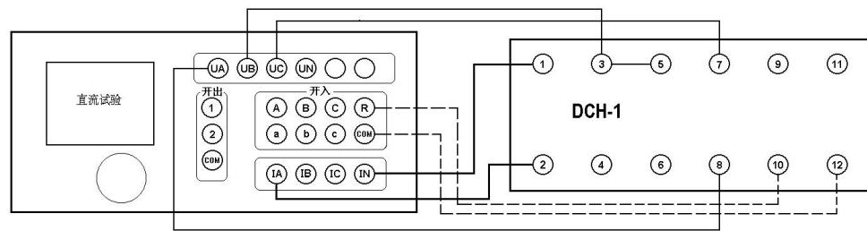
等待 15—25 秒重合闸电容充电充满、信号灯亮后，将  $U_c$  电压值改为 -110V (在输出状态中，鼠标点击  $U_c$  数值框，直接输入 -110，按回车键)，即在第 7 端施加启动电压以启动重合闸，重合闸启动后，等待重合闸时间到，接点动作，即可测出动作时间。
