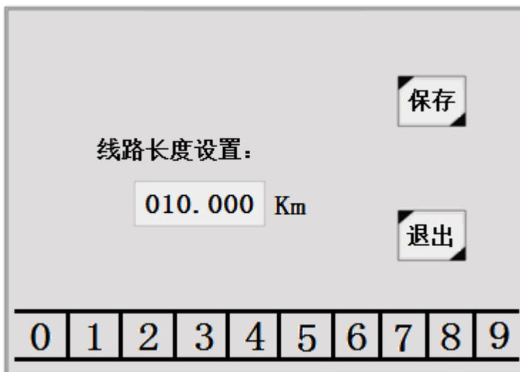
个模拟按键，其中，右边两个是保存和退出按键，下面是 0-9 的数字键，点线路长度输入框，然后，点需要的数字设置即可。若是输入错误，重复操作，确定正确，点<保存>键保存退出。
