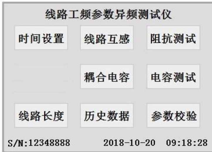
菜单界面（如图 4—1）。八个菜单的显示，每一个项目都有一个独立的显示区域，用户只需在相应的项目上面轻轻触碰一下就可以轻松的进入下一级具体操作菜单，整个过简单明了。省去了繁琐的按键操作。
