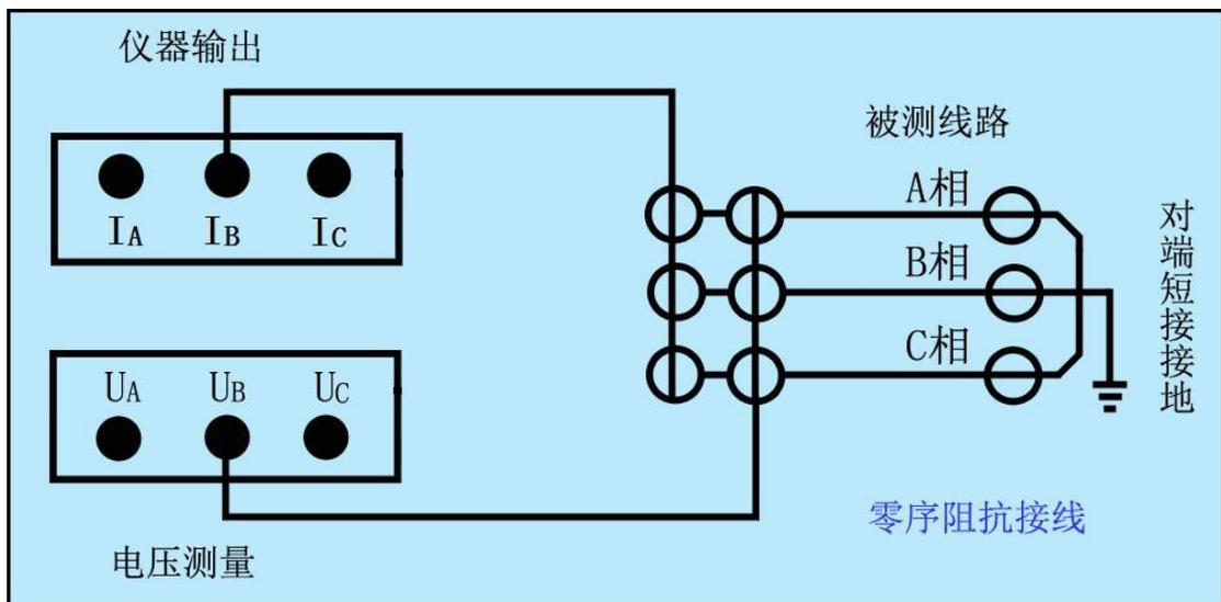
图 5—2、零序阻抗接线
