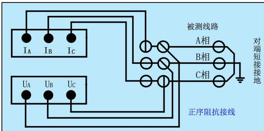
图 5—1、正序阻抗接线
